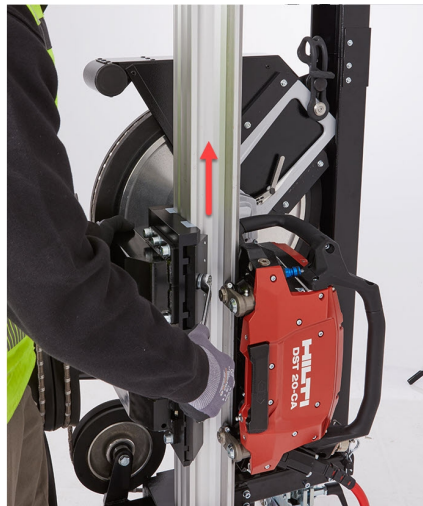
5. שחרר את הגלגל העליון של מחסנית הכבל, ודחף אותו על המסילה כלפי מעלה עד שכבל היהלום מתוח.
